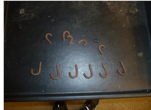
Von unten in gleichmäßigen Abständen, auf einer Linie, Löcher in das Holzstück einbohren (Bohrungsdurchmesser entsprechend der Gliedstärke). In diese werden nun die vorbereiteten Haken mit Pu- oder Heißkleber eingeklebt.
