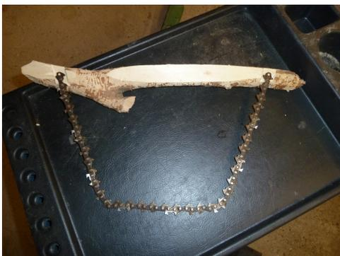
Dann kürzen wir die Motorsägenkette, für die Aufhängung, auf die gewünschte Länge (ca. 65 cm) und entfernen die Verbindungsnieten an den Enden. So erhalten wir die Löcher um die Kette später am Holz zu befestigen. (Alternative zur Motorsägenkette: Schnur, Faden, ...)
