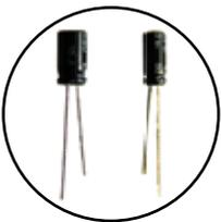
**6. Bauschritt: kleiner (4,7µF) und großer (10µF) Elektrolyt-Kondensator**
