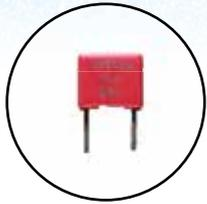
**3. Bauschritt: roter Kondensator zur Abhaltung von Störströmen mit 0,1  $\mu$ F**
